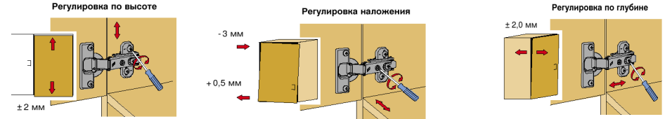
Рис.3 Схема установки петель
